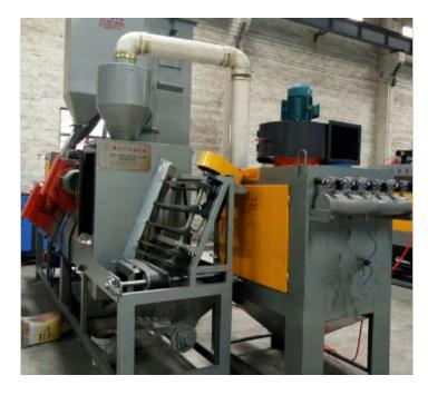
毛刺对产品质量的影响,影响产品的定位性能。粉末冶金多采用纵向压制,产品的侧面成形能力差。对于侧面含孔的零件,往往需要机械加工。毛刺的存在必然导致定位误差,从而影响孔的加工精度。对于精度要求比较高的零件,必须在机械加工之前,去除毛刺。此外,毛刺还影响了零件的检测精度。影响产品的装配性能。对一些装配要求较高的结构件,由于毛刺的存在易造成配合零件的干涉和卡死,如电机衬套、汽车减震器的导向套、底阀座、活塞等,毛刺的存在直接影响装配要求。由于模具压力中心跑偏与机床压力中心不重合而失稳,不仅产生较大的毛刺,而且还加速模具的磨损损坏,对设备的精度也会有一定的影响。这些问题会产生局部形状不规则毛刺。去毛刺机值得信赖,德之鑫有保证。上海去毛刺机报价
